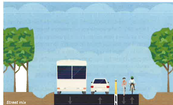
Coupe schématique montrant l'aménagement d'une piste multifonctionnelle sur le chemin Cambria et présentée à titre indicatif. L'élargissement de l'emprise du chemin permettrait d'aménager une piste d'environ 1,8 à 2m de large ou deux bandes unidirectionnelles d'environ 1m. Lors de la réfection du chemin, une évaluation plus précise des possibilités de réaménagement sera effectuée.
